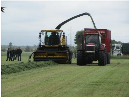
Picture 19. Forage harvester. Photo: Henning Sjørslev Lyngvig
